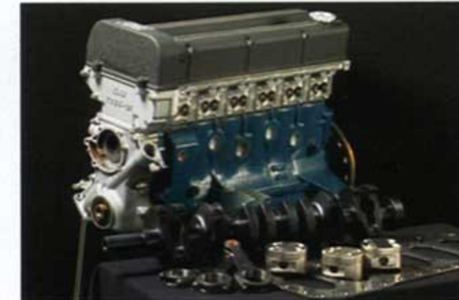
L28エンジンで使うのはブロックのみ。その他のパーツは最新の製造技術を用いてOS技研で製造される。駆動はチェーンのほかカムギヤトレインも選べる
