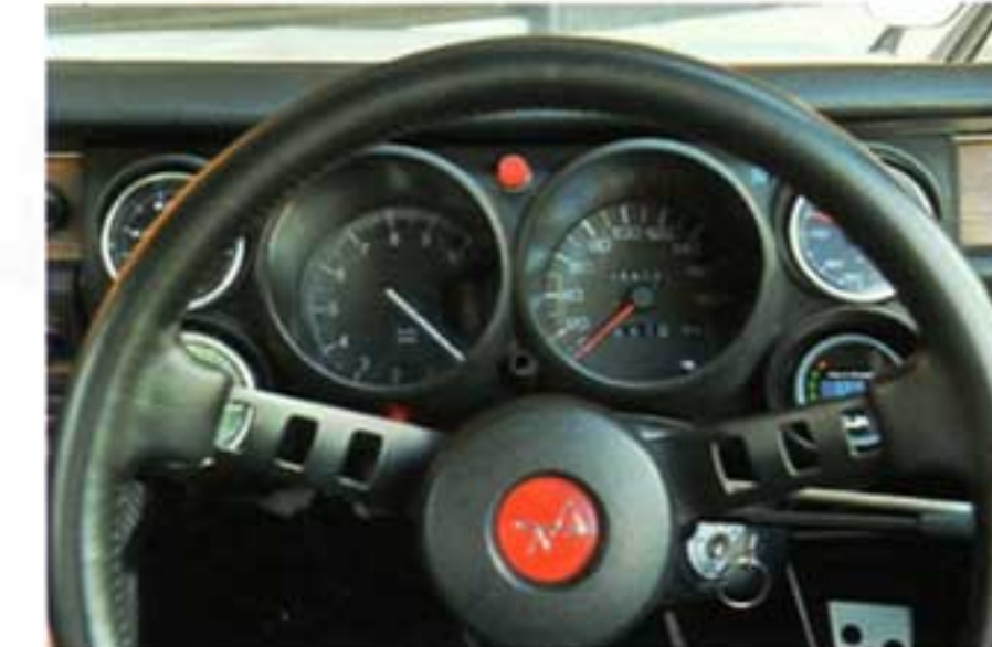
メーター類はすべてオリジナルではないが、雰囲気損なわないように同位置に。スピードメーターはシルビア用。ただし、全開時は見ている余裕がない
