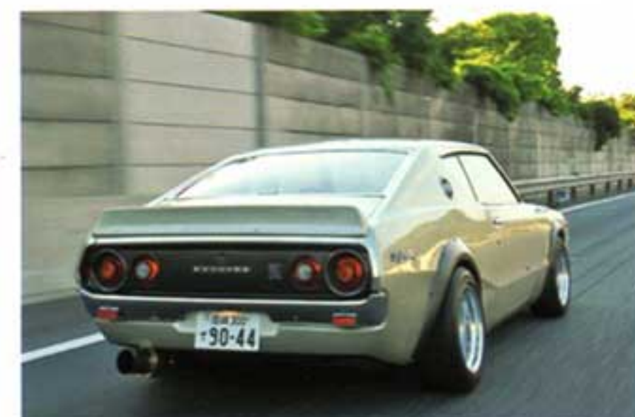
ABCピラーをカットして、ケンメリのボディを被せているが、オリジナルのロールケージ(室内には見えない)や補強を加えることで、十分な剛性を確保
