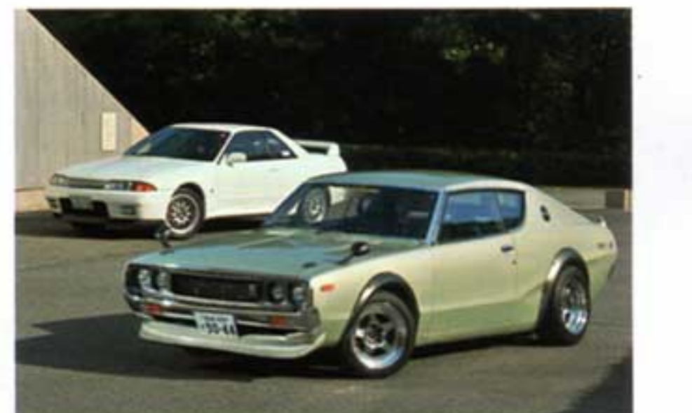
外観にはベースのR32の面影はなく、完璧にケンメリ。ボディは5層構造のFRPで、強度も十分。細部はリプロパーツを使うが、一部はオリジナルで成型!
