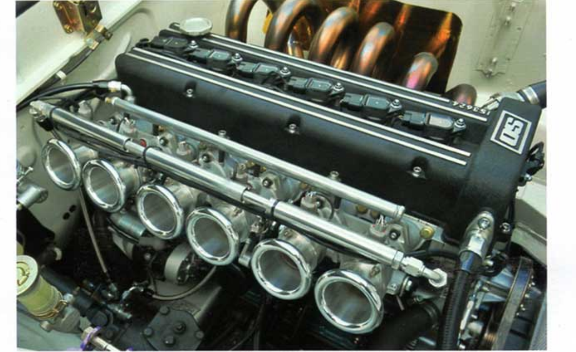
TC24-B1Zのプロト第2弾となるこのエンジンはダイレクトイグニッションやSARD製の12ホールインジェクターを採用し、モータックで制御している。パワーと扱いやすさを追求した現代版
