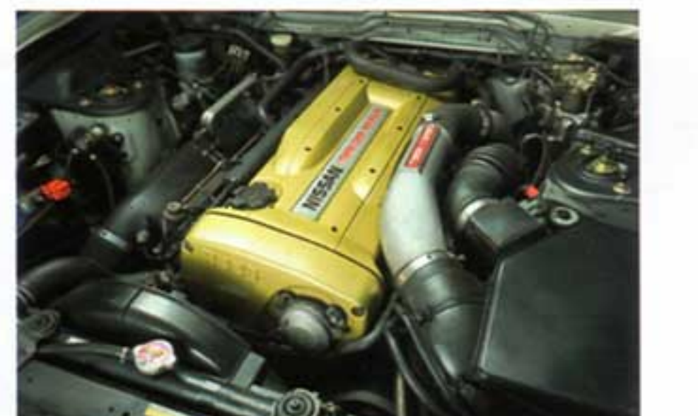
エンジンを開けるとR32の世界が広がる。ヘッドカバーを塗り替えているが、RB26はオリジナル。200kgほど軽いので、走りは想像以上に力強く軽快
